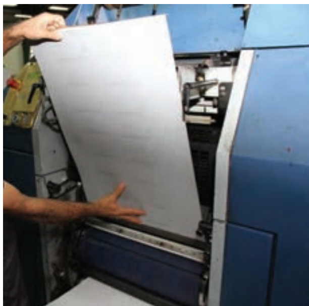
شکل ۶۹- قرار دادن لب کار در شیار سیلندر
