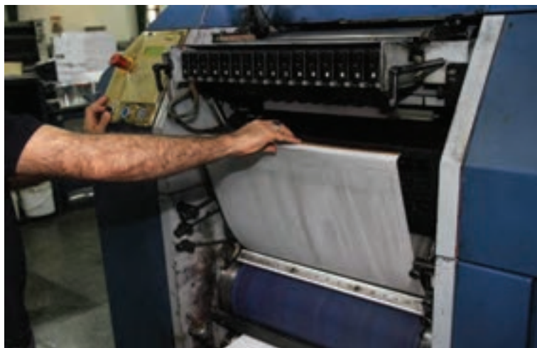
شکل ۵۶- نگه‌داشتن پلیت برای بازکردن از روی سیلندر
