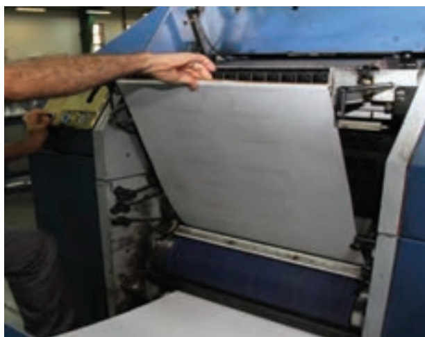
شکل ۷۰- بسته شدن پلیت دور سیلندر با دور کند
